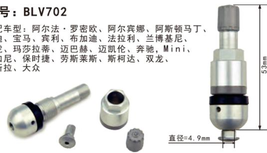
气门芯扭矩: 0.35Nm 螺母扭矩: 4.0Nm 螺钉扭矩: 4.0Nm
