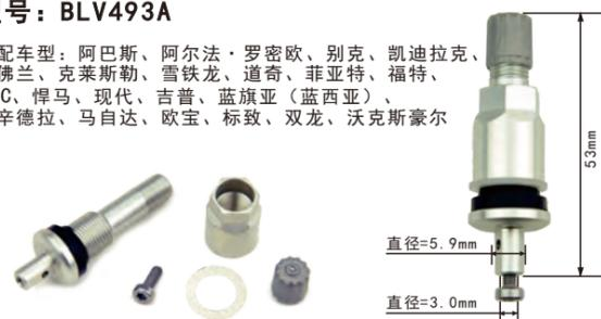
气门芯扭矩: 0.35Nm 螺母扭矩: 4.0Nm 螺钉扭矩: 1.4Nm
