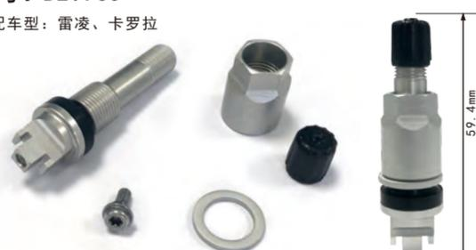
气门芯扭矩: 0.35Nm 螺母扭矩: 3-5Nm 螺钉扭矩: 1.2Nm
